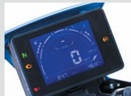
Η LDC οθόνη με μπλε φόντο και λευκές ψηφιακές ενδείξεις, προβάλλει όλες τις απαραίτητες πληροφορίες παραμένοντας ευανάγνωστη ακόμα και σε κόντρα ήλιο, ενώ ακριβώς από κάτω, σε αρκετά πρακτική θέση, βρίσκεται μια θύρα USB για φόρτιση ηλεκτρικών συσκευών.
