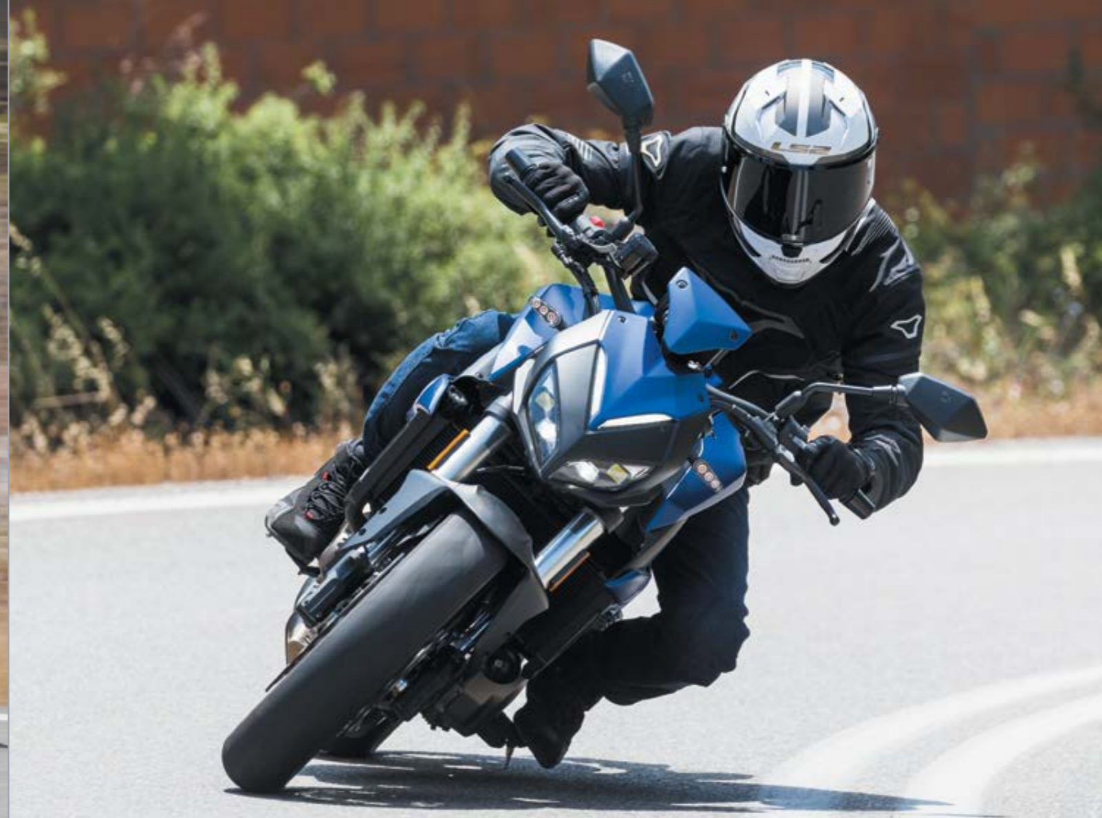
Ο δικύλινδρος εν σειρά κινητήρας με χωρητικότητα 698 κ.εκ., αποδίδει 73,5 ίππους και 6,8kg-m μέγιστη. Δεν διαθέτει ηλεκτρονικά βοηθήματα ούτε ξεχωριστές καρτογραφίες, αλλά τοντάρει στις επιδόσεις κρατώντας παράλληλα το κόστος χαμηλά.
