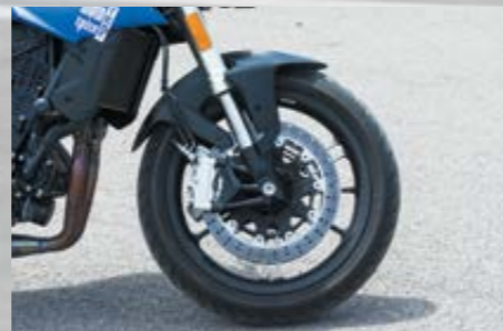
Το ανεστραμμένο 43αρι πιρούνι συνεργάζεται με ακτινικές τετραπίστονες δαγκάνες, δίσκους 320 χιλιοστών και σύστημα ABS 9.1 της Bosch. Με ένα aftermarket σετ ελαστικών θα αποδώσουν ακόμα καλύτερα.
