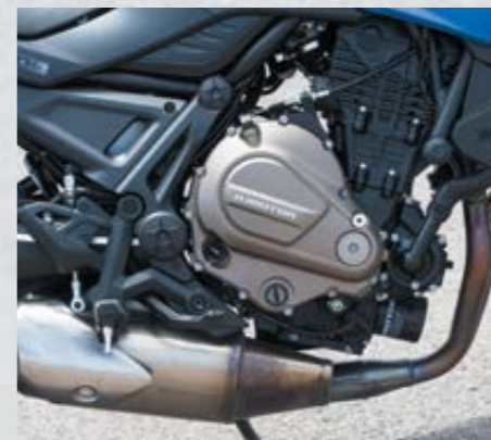
Ο δικύλινδρος εν σειρά κινητήρας με χωρητικότητα 698 κ.εκ., αποδίδει 73,5 ίππους και 6,8kg-m μέγιστη. Δεν διαθέτει ηλεκτρονικά βοηθήματα ούτε ξεχωριστές καρτογραφίες, αλλά τοντάρει στις επιδόσεις κρατώντας παράλληλα το κόστος χαμηλά.
