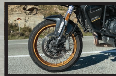
Στον τομέα της πέδησης, η SRT 900SX παίζει δυνατά με χαρτιά. Εμπρός διαθέτει δύο δίσκους 320 mm με τετραπίστονες ακτινικές δαγκάνες Brembo και ακτινική τρόμπα, προσφέροντας άμεση αίσθηση στη μανέτα και σταθερή απόδοση, ακόμα και σε επαναλαμβανόμενα δυνατά φρεναρίσματα.
