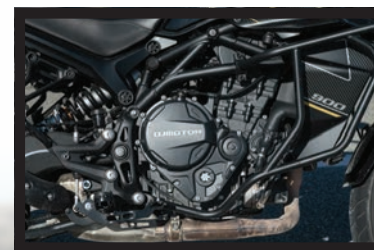
Στην καρδιά της QJMOTOR SRT 900SX βρίσκεται ένας δικύλινδρος εν σειρά κινητήρας 904 κ.εκ., υγρόψυκτος, με τέσσερις βαλβίδες ανά κύλινδρο και δύο επικεφαλής εκκεντροφόρους (DOHC).
