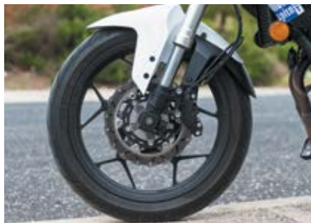
Δυο δίσκοι εμπρός δεν συναντάμε συχνά σε μοτοσυκλέτες αυτής της κατηγορίας. Συνεργάζονται με τετραπίστονες δαγκάνες.
